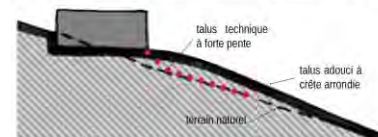
Principe de remblai en pente douce
